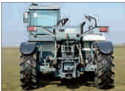
De hef tilt tot 3,7 ton, de aftakas brengt tot 26 kW over. Goed voor simpele werktuigen.
